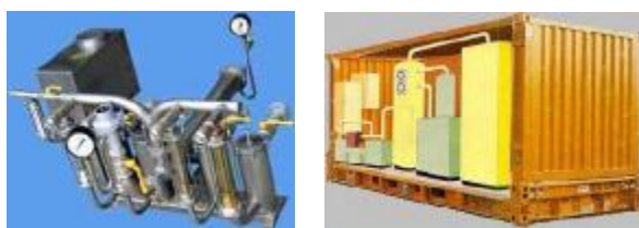
Рис.2. Внешний вид системы для производства биодизеля и ее компоновка для производства биодизеля в контейнере
